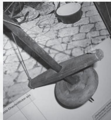
Drillbohrer zum Bohren von Keramik.
